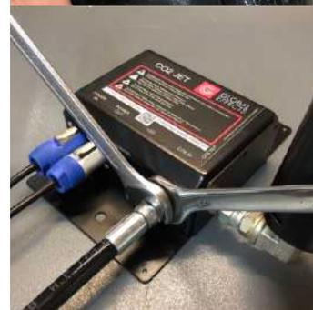
(прокладки, фум-лента и т.п.) **категорически запрещается** во избежание попадания мелких частиц отработки в систему и клапан.
