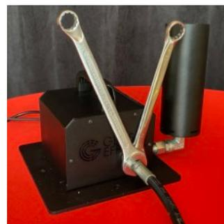
8. Криопушка может работать в двух режимах управления: DMX или 220В. *Обращаем внимание, что в режиме управления 220В (10-й dip) клапан криопушки может срабатывать с задержкой до 1 сек.*
