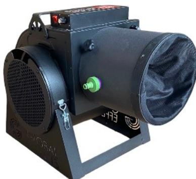
Для работы с генератором пены Foam Eco используйте стойку (не менее 3 метров высотой) либо ферму для подвеса генератора.
