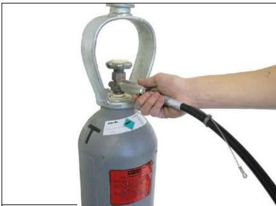
Другой конец шланга подсоедините к баллону с CO<sub>2</sub> (с погружной трубкой).
