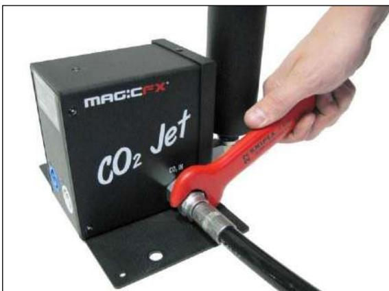
Подсоедините шланг к устройству CO<sub>2</sub> Jet и закрепите его, например, гаечным ключом (размер 22).
