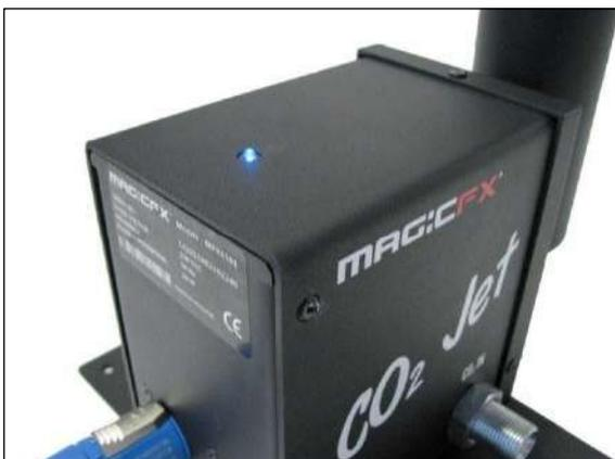
Для проверки сначала необходимо установить, находится ли газовый клапан на баллоне с CO<sub>2</sub> в закрытом положении. Теперь вы можете проверить правильность установки устройства CO<sub>2</sub> Jet, включив и отключив электропитание. Если система подключена правильно, вы услышите щелкающий звук, который возникает при открытии и закрытии магнитного клапана в устройстве CO<sub>2</sub> Jet.
