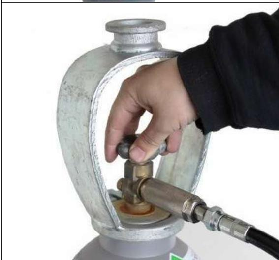
Когда система подключена правильно, вы можете открыть клапан баллона с CO<sub>2</sub>. Проверить на наличие утечки. Если газовый шланг подсоединен неправильно, газ может вытекать. В этом случае затягивайте муфты до тех пор, пока утечка газа не будет прекращена.
