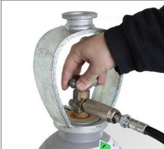
Закройте вентили газового баллона.
