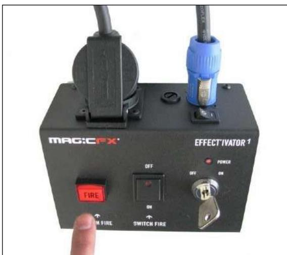
Для управления устройством CO<sub>2</sub> Jet, вы включаете и выключаете переключатель. Как только вы нажмете на переключатель, магнитный клапан сразу откроется, и из устройства CO<sub>2</sub> Jet начнет выходить белый дымовой шлейф.
