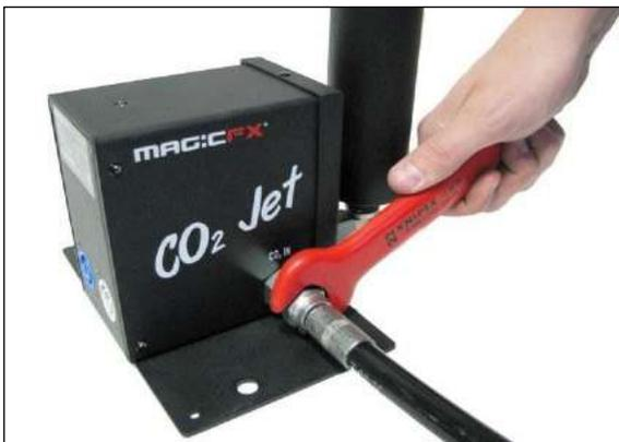
Только при отсутствии в шланге газа, такой шланг может быть отсоединен от газового баллона и устройства CO<sub>2</sub> Jet.
